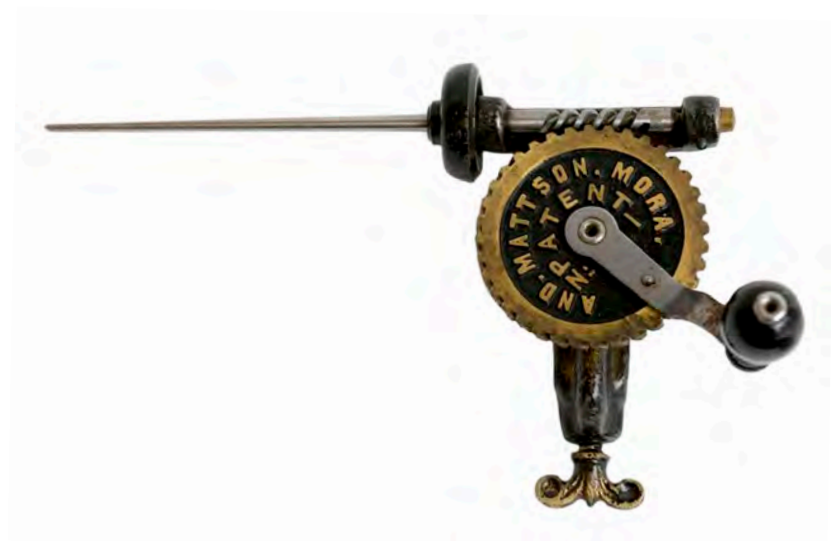
Bild 29. Spolmaskin för vävgarn, tänkt att fästas i bordskant, troligen omkring 1900.
