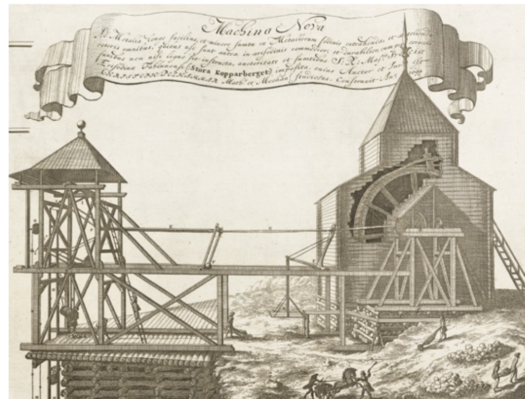
▲ POLHEMS UPPFORDRINGSVERK MACHINA NOVA vid Stora kopparberget i Falun, mer bekant som Blankstötsverket, stod klart 1694. Det kom att effektivisera transporten av malm till markytan och maskineriet ersatte tidigare hissanordningar med rep av dyra oxhudar. Förslagan till Machina Nova utgjordes av en modell som Polhem (i olika versioner) förevisat för Bergskollegium och ”konung Carl XI, som var en god kännare, så nådigt ansedt, at han tilldelade Upfinnaren 500 Daler Silfverm. årligen lön såsom Bergs-mechanicus”, som det hette i Vetenskapsakademiens åminnelsetal över Polhem 1753. Förarbetet till gravyren – som ingår i Erik Dahlberghs Suecia antiqua et hodierna (1715) – tecknades av modellbyggare Samuel Buschenfeldt.
