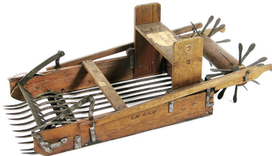
▲ MODELL AV EN SÅ KALLAD STENÅKA, tillverkad kring år 1740, ”hwar med then grofwa sten af åkren kan bortföras”. Modellen ingick i den förteckning som modellör Johan Norberg sammanställde 1749 över Polhems äldre modeller. Med all sannolikhet kom modellen aldrig till användning som fullskaligt redskap. Fotografi från Nordiska museet.
