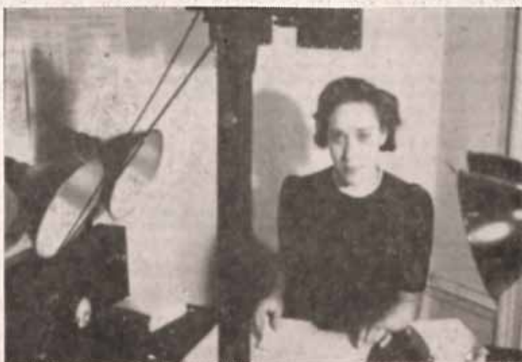
Fotoflicka hos pensionsstyrelsen i fullt arbete. Överst skymtar kameran, på sidorna de fyra lamporna. Kortet placeras sex i taget på bordet och exponeringen går på några sekunder.
